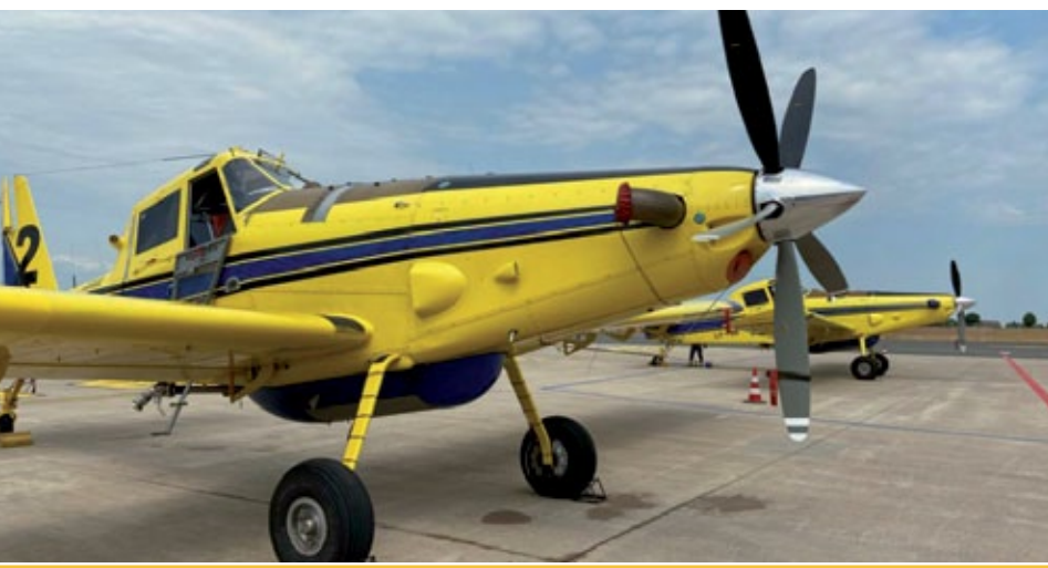
Das Löschflugzeug Air Tractor AT 802/A ist rund 7,5 Tonnen schwer und kann rund 3.000 Liter Löschwasser aufnehmen.
